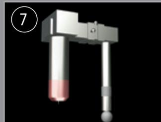
7 МЕХАНИЧЕСКИЙ ЩУП ДЛЯ ОТСЛЕЖИВАНИЯ СВАРНОГО ШВА
