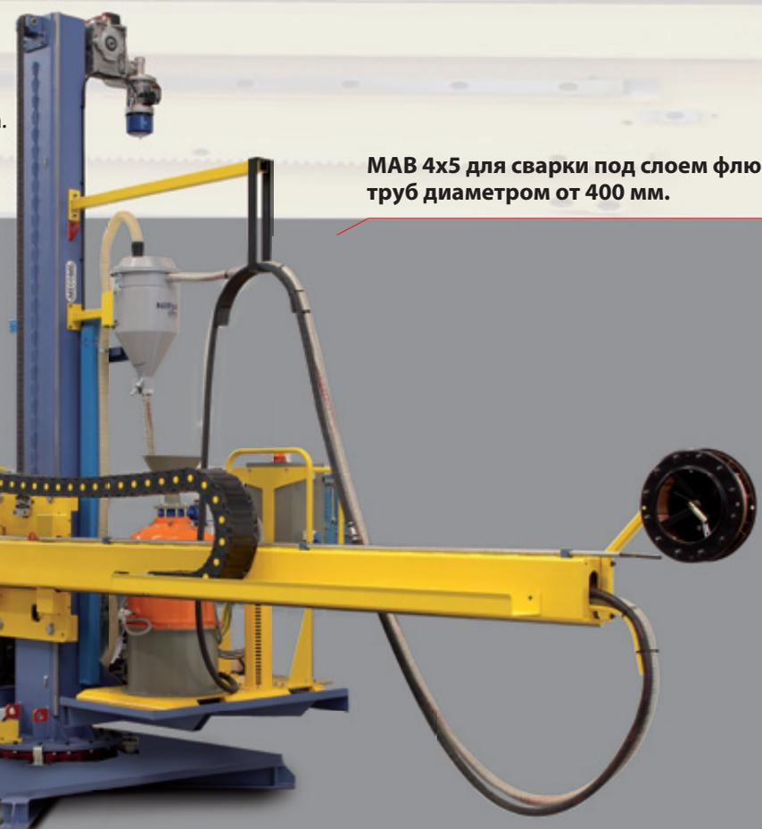
MAV 4x5 для сварки под слоем флюса труб диаметром от 400 мм.
