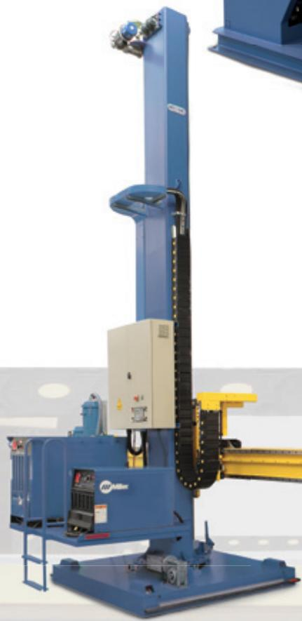
MAV 6x6 для сварки под слоем флюса, тандемом, камерой и системой поиска шва.
