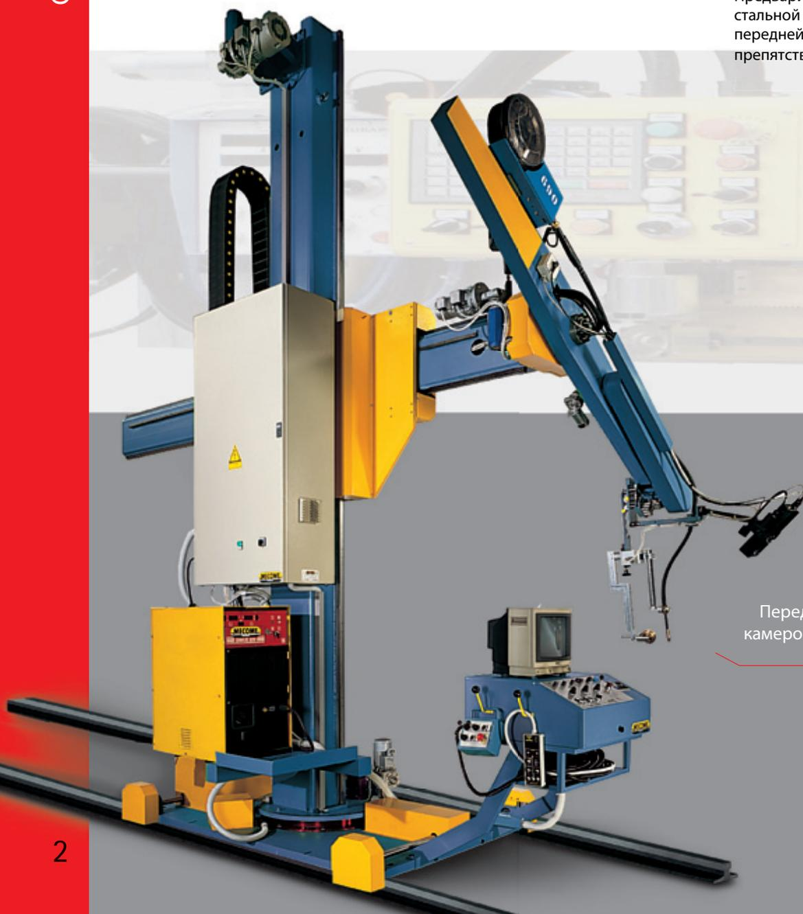
Передвижная сварочная колонна с камерой и механическим устройством для поиска шва.
